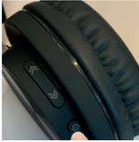
Halten Sie die Taste am Kopfhörer 1–2 Sekunden lang gedrückt, bis das Licht an der Unterseite des Kopfhörers abwechselnd blau und rot blinkt. Der Kopfhörer ist nun bereit, sich zu verbinden.
