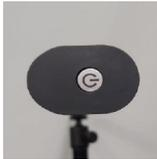
Schalten Sie den Lichtstab EIN, indem Sie den Einschaltknopf auf der rechten Seite des Lichtstabs kurz gedrückt halten. Eine blaue Leuchte blinkt sowohl am Knopf als auch am Lichtstab, was anzeigt, dass er bereit ist, sich zu verbinden
